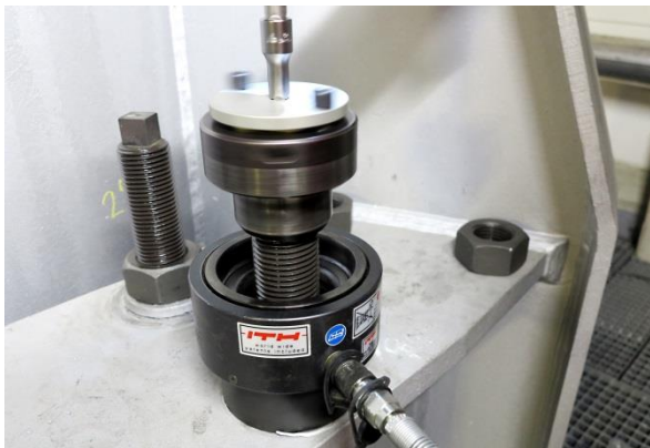
A bucha de conexão flexível move-se no corpo do cilindro
